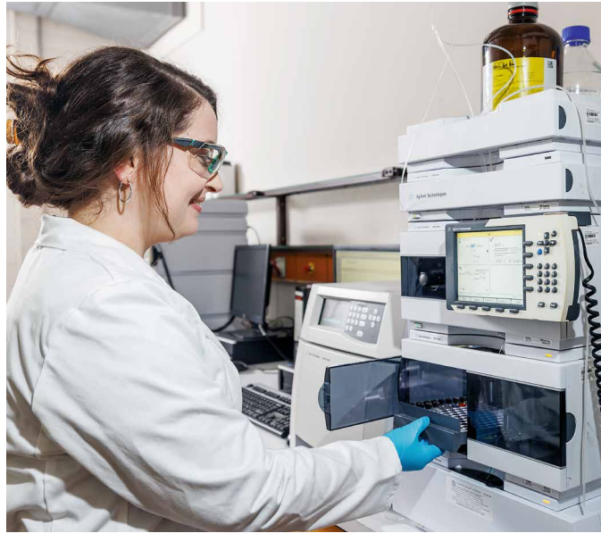
Chromatographen trennen Stoffe in ihre Bestandteile auf. So können die Zusammensetzungen von Mischungen oder die Molekulargewichtsverteilung von Polymeren untersucht werden.
