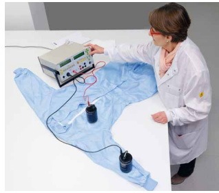
Bestimmung des Punkt-Punkt-Widerstands an Reinraumbekleidung für den ESD-Bereich
