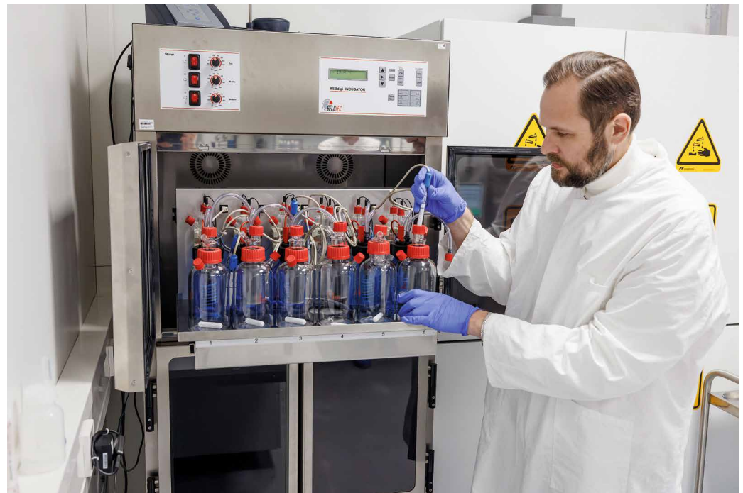
Der Respirometer untersucht, wie sich eine Probe abbaut. Er misst die Austauschrate von Sauerstoff und Kohlendioxid – also welche Menge von den Mikroorganismen „veratmet“ wird. Je mehr sie atmen, umso mehr wird biologisch abgebaut.
