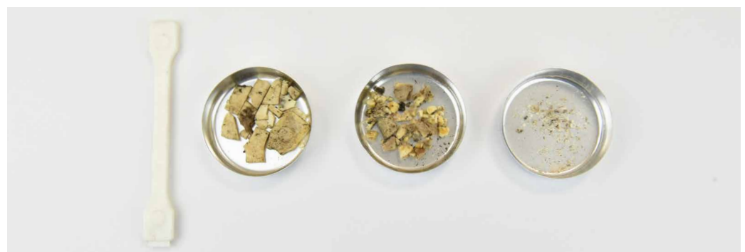
Die im Bild zu sehende ARBOBLEND®-Variante von der Firma TECNARO wird im Routinebetrieb einer Bioabfall-Kompostierungsanlage abgebaut. Von li nach re: vor der Kompostierung, nach 2 Wochen, nach 6 Wochen, nach 12 Wochen.
