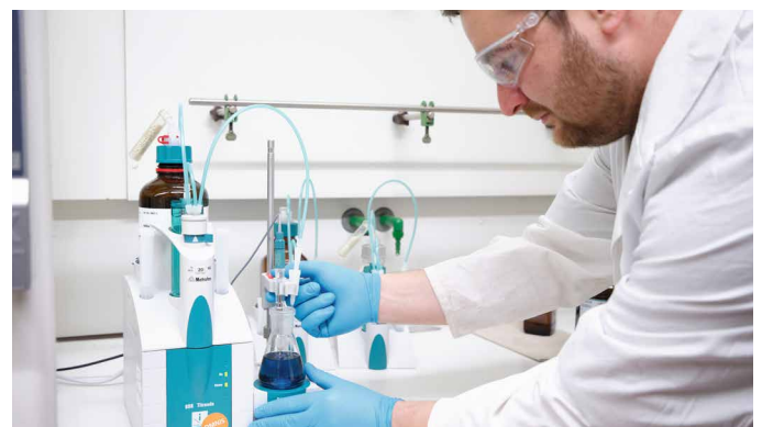
Mit der automatisierten, potentiometrischen Titration werden Endgruppen und damit z. B. Molekulargewichte von Polymeren bestimmt.
