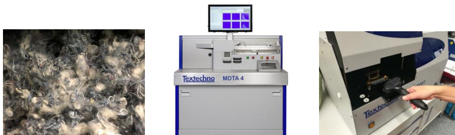
Abb.1 Recyclingfaserprobe (Links), Klassifizierung der Recyclingfasern mittels MDTA-4 (Mitte) und Fibrotest-Messgerät der Firma Textechno (Rechts)
