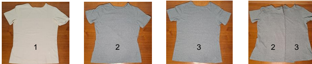
Abb.3 Gestricke (T-Shirts) aus: Primärbaumwolle, 3fach-Vorreißer (1) Mischung 50/50 % Rezyklat/Primärbaumwolle, 3fach-Vorreißer (2) Mischung 50/50 % Rezyklat/Primärbaumwolle, Avantrain-Aggregat (3) Mischung 50/50 % Rezyklat/Primärbaumwolle im Vergleich (2, 3)
