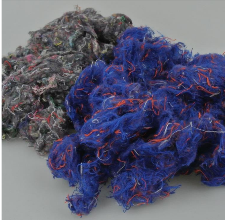
Alttextilien nach dem Reißprozess. Hinten: Baumwolle, vorne: Aramid. Foto: DITF
