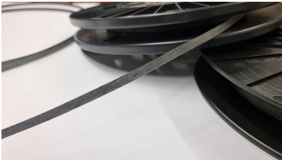
Tapes für Hochleistungsanwendungen hergestellt aus recycelten Carbonfasern. Foto: DITF.
