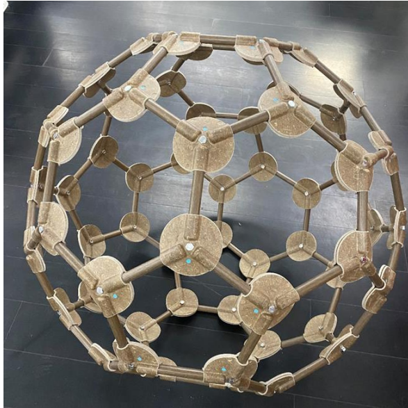
Finale Struktur als Buckyball mit den entwickelten Knoten und Pultrusions-Profilen. Foto: Carsten Fulland, Zenvision
