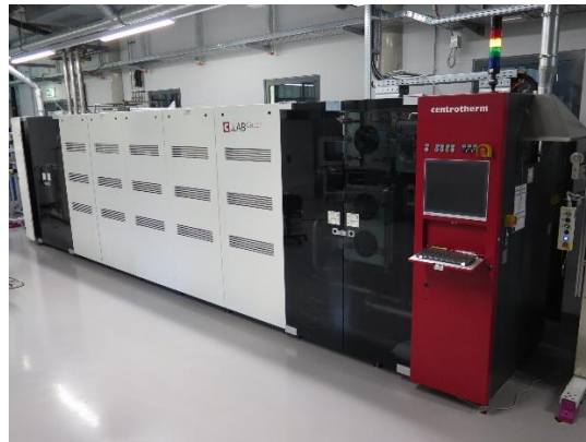
Bild 1: Stabilisierungsofen für die Oxidation von PAN-Fasern. Foto: DITF
