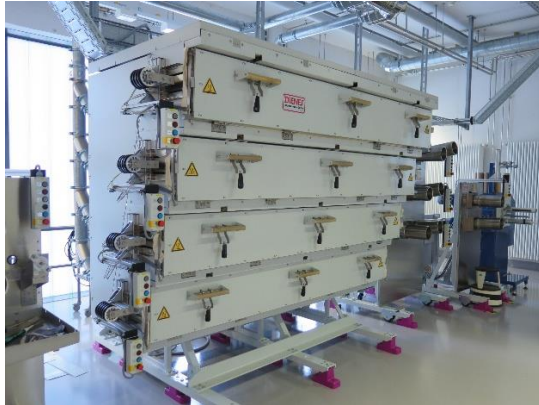
Bild 1: Stabilisierungsofen für die Oxidation von PAN-Fasern. Foto: DITF
