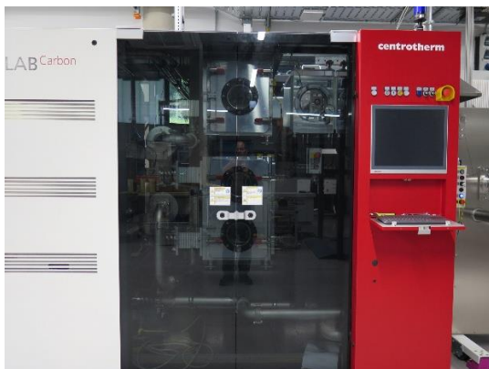
Bild 3: Schleusensystem des Niederdruckofens. Foto: DITF
