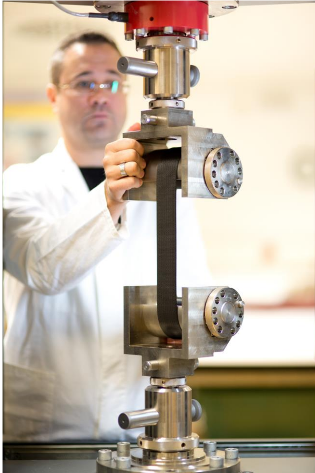
Standard- anwendungsorientierte Prüfungen an Fasern, Garnen und textilen Flächengebilden (Foto: DITF)
