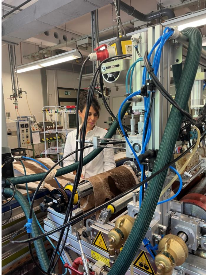
Beschichtungsprozess eines zellulosebasierten Vliesstoffs mit dem Lignin-Compound als Heißschmelzauftrag auf einer kontinuierlichen Beschichtungsanlage. Foto: DITF
