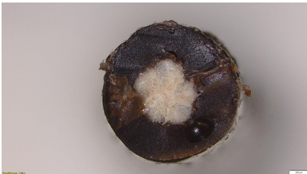
Querschnitt eines durch thermisches Extrusionsverfahren mit Lignin beschichteten Baumwollgarne. Foto: DITF
