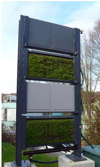
Modulare Mooswand: MoosTex-Testaufbau auf dem DITF-Gelände in Denkendorf. Foto: DITF
