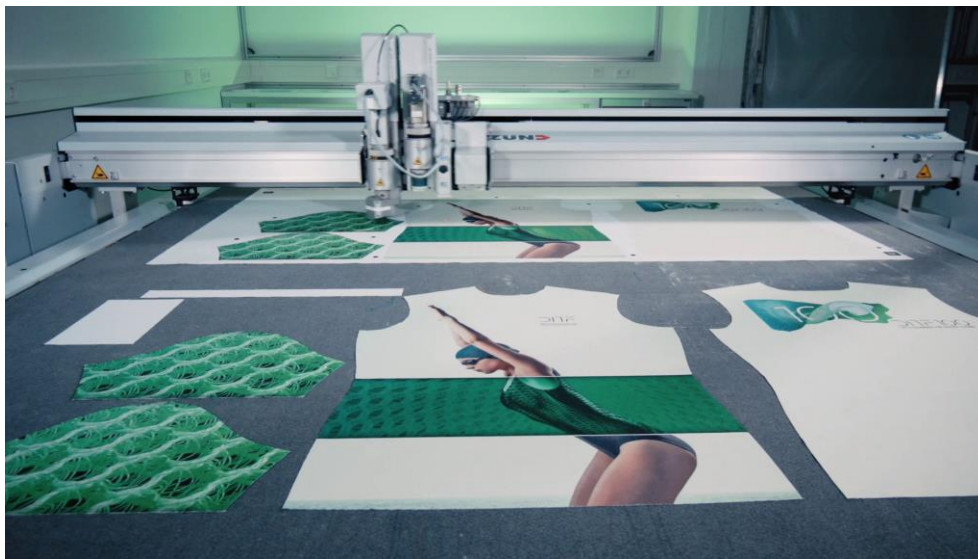
Automatisierter Zuschnitt von individualisierter Bekleidung am Einzellagen-Cutter. Foto: DITF
