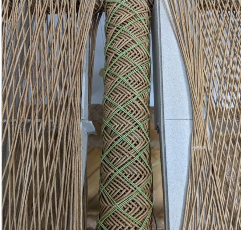
Strukturgespultes Papiergarnelement mit grünem Sensorgarn. Foto: DITF
