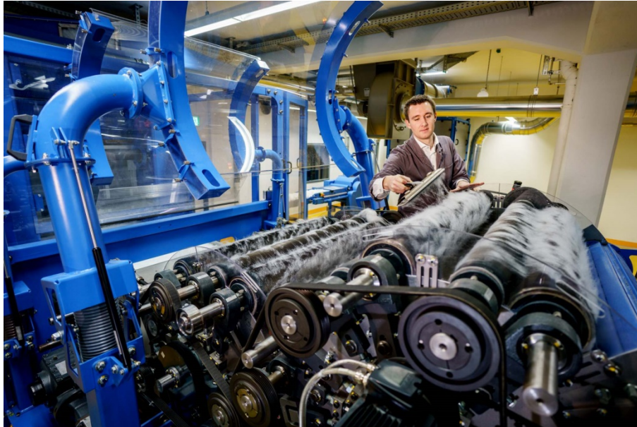
Reinigungsarbeiten an den mit Fasern belegten Arbeitsorganen der Krempel. Foto: DITF
