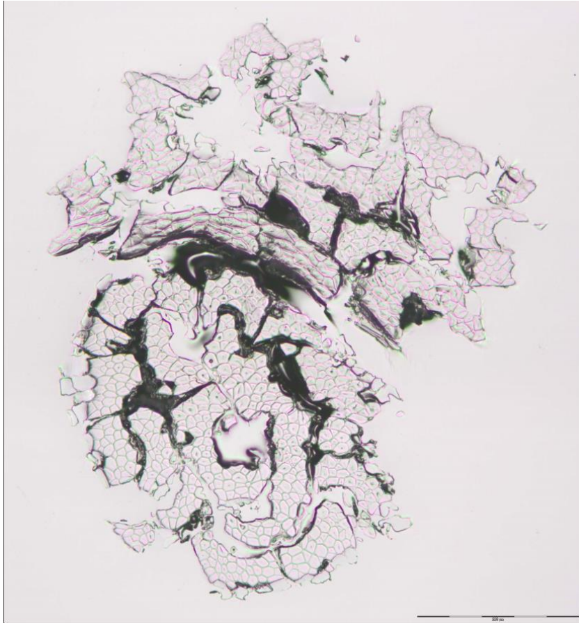
Queransicht. Gespleißter Zwirn aus gerottetem Lindenbast. Gut erkennbar die Fasergruppen im festen Verbund. Foto: DITF
