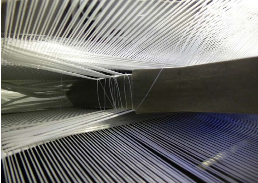
Abb. 3: Herstellung von Abstandsgewebe, Blick zwischen die Deckschichten während der Produktion (Foto: DITF)
