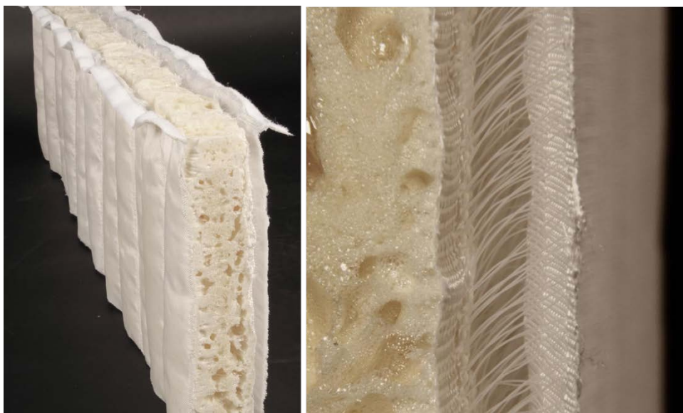
Abb. 2: Abstandsgewebe, links horizontal aufgestellt und manuell mit PU-Schaum ausgeschäumt, rechts Schnitt durch Dämm- und Hinterlüftungsebene (Fotos: FRA-UAS)
