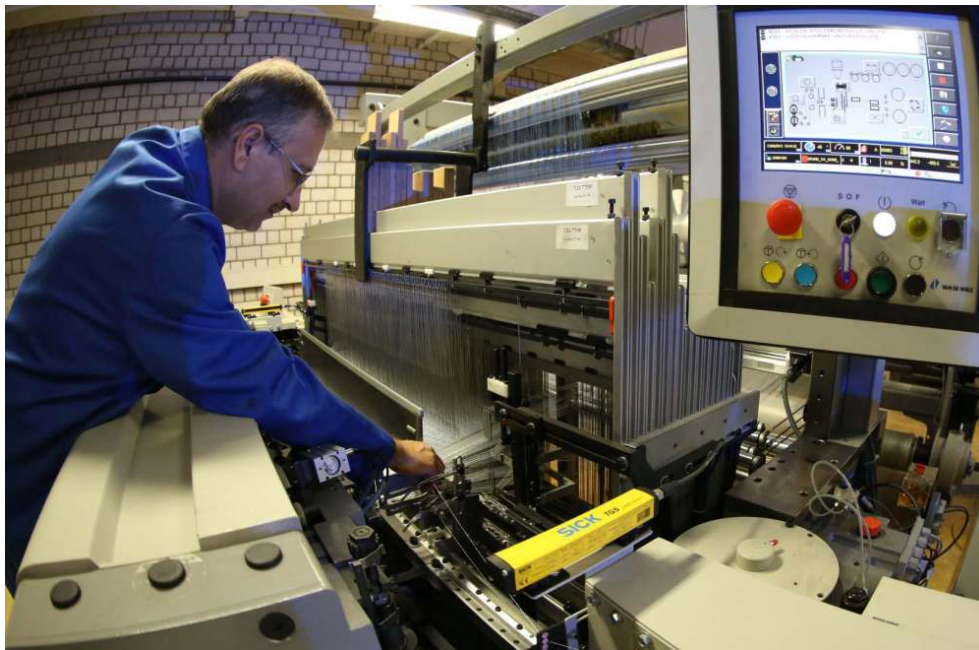
Abb. 4: Abstandswebmaschine mit horizontalem Produktionsprozess (Foto: DITF)
