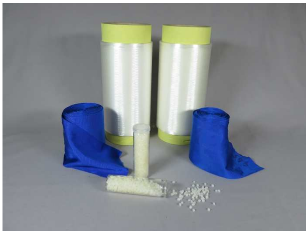
Abbildung: Granulat, Fasern und gefärbtes Gewebe aus flammgeschütztem Polyamid
