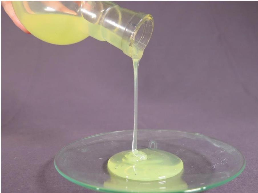
*Bild 1 und 2: Spinnmasse für Keramikfasern*
