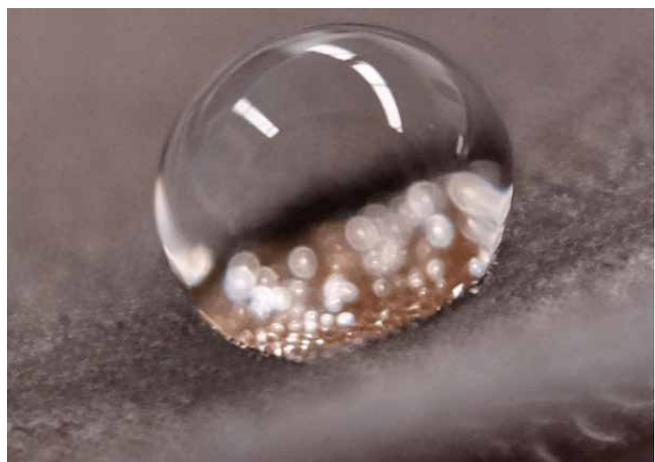
Erhöhte Wasserabweisung auf einer Beschichtung mit speziellen Mikrostrukturen
