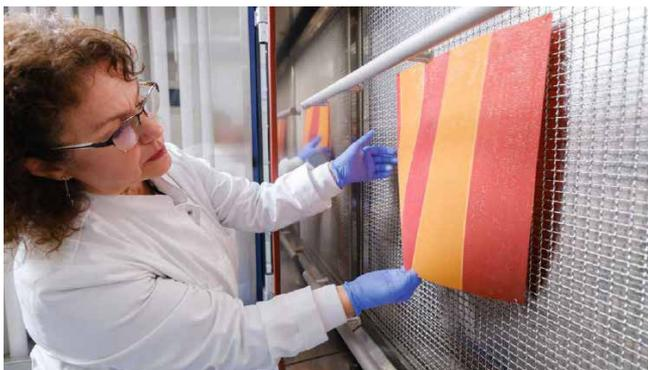
Entnahme der u. a. mit Regen bewitterten Markisenstoffprobe für weitere Prüfungen
