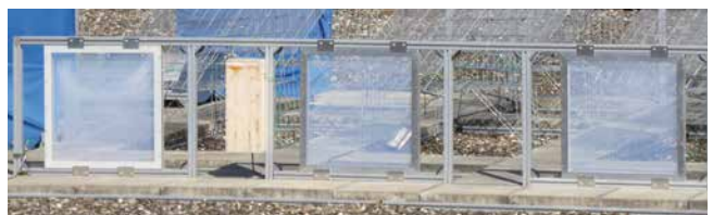
ETFE-Fassadenelemente in der Außenbewitterungsanlage der DITF
