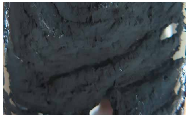
Cellulosephosphit-Beschichtung nach der Intumeszenz, beschichtetes Substrat darunter ist weitgehend erhalten
