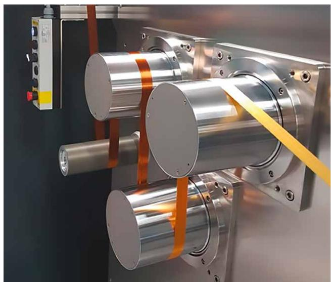
50K-Polyacrylnitril-Precursor beim Auslauf aus dem Niederdruckofen
