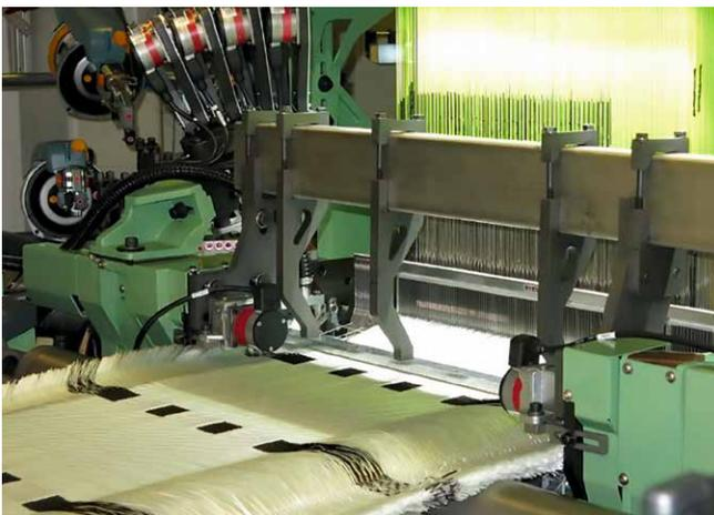
Fertigung eines sensorischen Mehrlagen-gewebes
