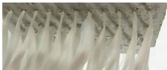
In Beton eingebettete Cellulosefilamentgarne
