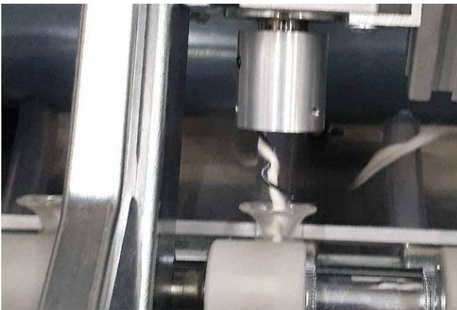
Drallorgan vor dem Streckwerk einer Ringspinnmaschine
