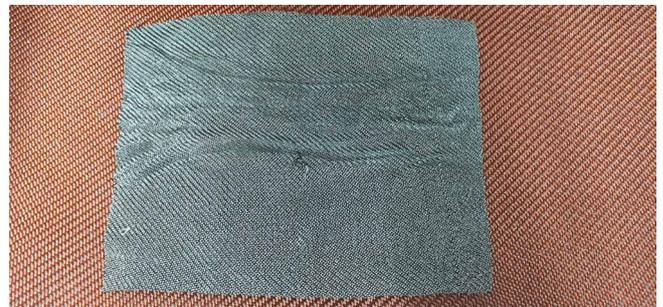
Gewebe aus Lignin und ein Carbonfaserpatch aus Lignin
