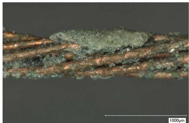
Analyse von Smart Textiles hinsichtlich der Schweißbeständigkeit
