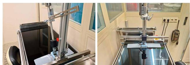
Projektspezifisch weiterentwickelte Wischsimulationseinrichtung im Messreinraum der DITF. Die neue Sensorik ist im und oberhalb des Gelenkes des Wischmopphalters eingebaut
