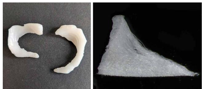
Links: 3D-gedruckter, rechter Meniskus aus MRT-Daten einer Patientin; rechts: Schnitt durch einen Meniskus-Scaffold hergestellt mittels Kombination aus MES und MEW
