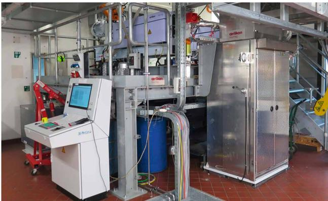
Bikomponenten-BCF-Spinnanlage der Firma Oerlikon Neumag
