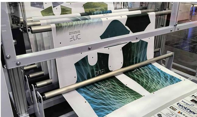
Materialpuffer der Digital Textile Micro Factory auf der drupa 2024 mit zwischengespeicherten Produktionsaufträgen nach dem Druck und vor dem Zuschnitt
