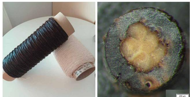
Baumwollgarn mit und ohne Ligninbeschichtung (links) und Mikroskopbild des Garnquerschnittes mit Ligninbeschichtung (rechts)
