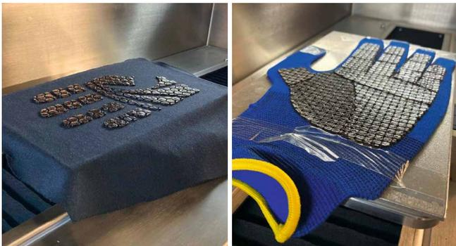
Bedruckte Textilien mit einer Lignin-Beschichtung für die Verwendung in Handschuhen
