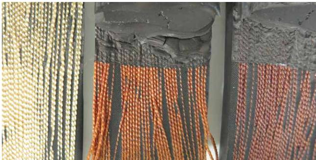
Haftung von Polyamid 6.6 an Kautschuk: ohne Haftvermittler (links), mit RFL-Dip (Mitte), mit HMF-Dip (rechts)
