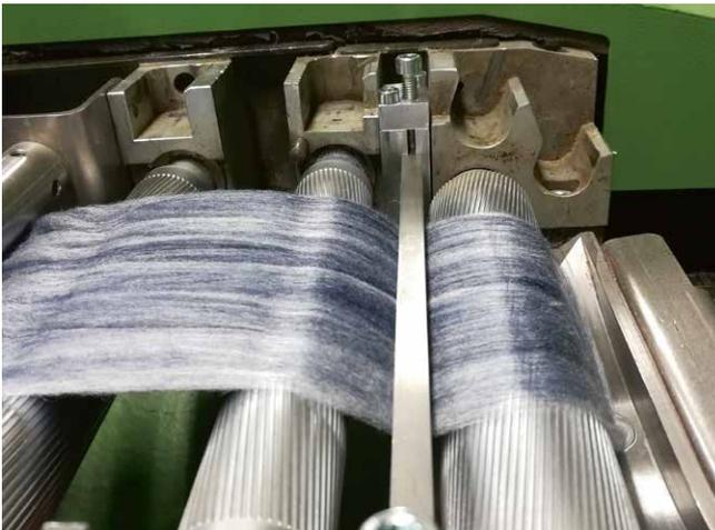
Entwickeltes Faserführungselement mit optimierter Position im Streckwerk einer Strecke
