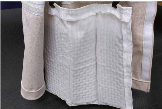
Handmuster des montierten Sandvorhangs mit Faltungslinien
