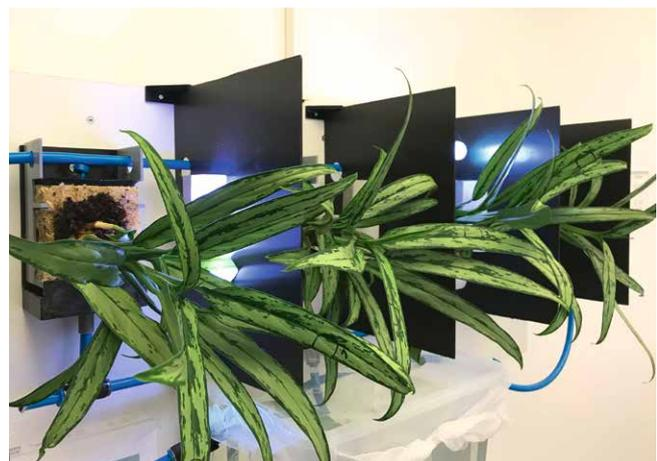
Versuchsaufbau für die Entwicklung von Living Walls
