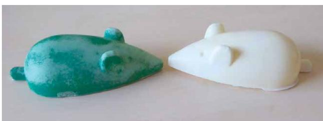
In-situ polymerisierte Demonstratorbauteile, hergestellt mit dem Rotationsguss
