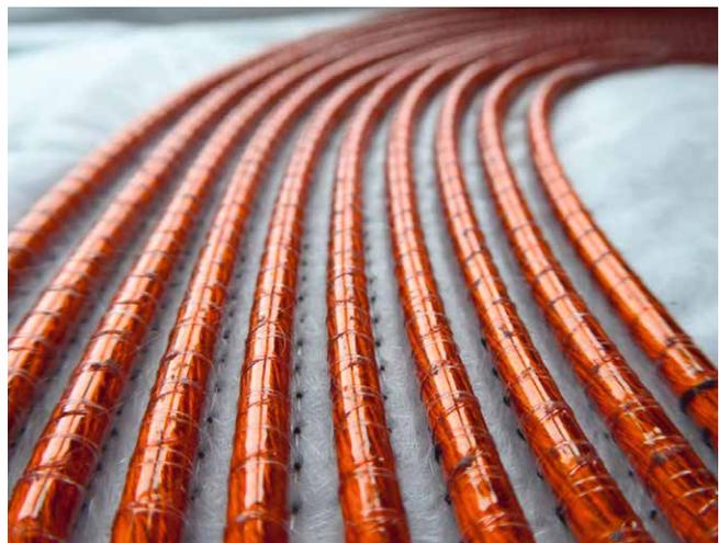
Aufgestickte Kupferspule auf dem Trägertextil
