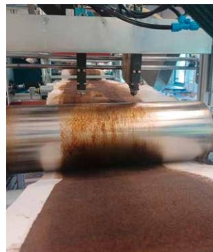
Beschichtung eines Zellulosevliesstoffes mit Lignin
