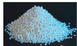
Oben: Schema der Polymersynthese; unten links: Aufbau der Kern-Mantel-Bikomponentenfasern, unten rechts: An den DITF synthetisiertes, flammgeschütztes PA6-Granulat
