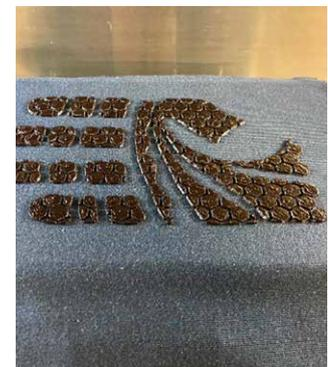
Mit Lignin im 3D-Druck beschichtetes Textil
