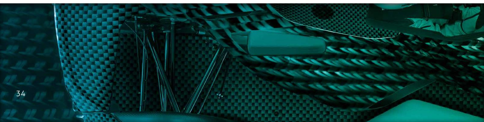
Mittels des an den DITF etablierten Computertomographen kann das Bauteil bis auf die kleinste strukturelle Ebene untersucht werden. Einerseits werden Schwachstellen wie Mikrorisse, fehlende Fasern oder Faserfehlstellungen nachgewiesen, andererseits wird damit eine optimale Führung der Fasern mit höchster Ausnutzung der Festigkeiten ermöglicht.
