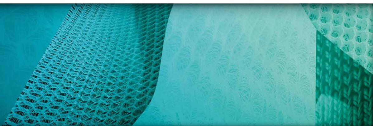
Die direkte Absorption und Desorption von Kohlenstoffdioxid aus der Umgebungsluft wird durch neuentwickelte Filtermaterialien auf Basis von Vliesstoffen aus funktionalisierten Cellulosefasern ermöglicht.
