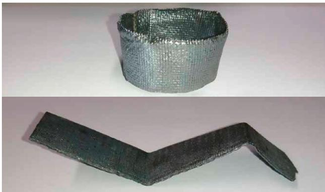
Faserverstärkte, keramische Verbundwerkstoffe ausgehend von reinen Celluloseverbundwerkstoffen in der Form eines Z-Profiles und Rohrs
