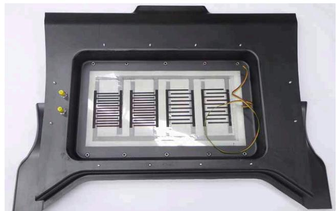
Heckboden mit integriertem Insert, Wasseranschlüssen und gedrucktem Feuchtigkeitssensor
