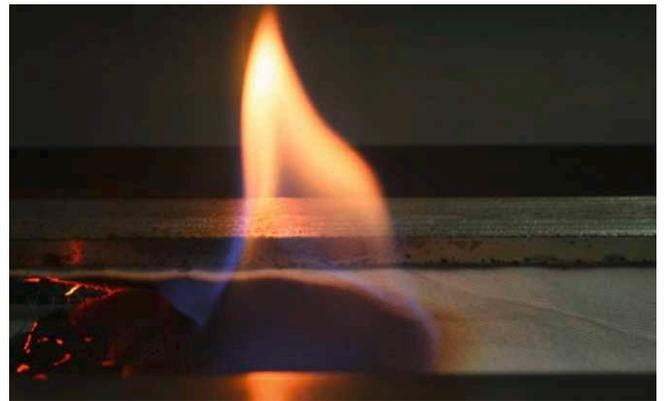
Horizontaler Brandtest an einem nicht flammfest ausgerüsteten Textil
