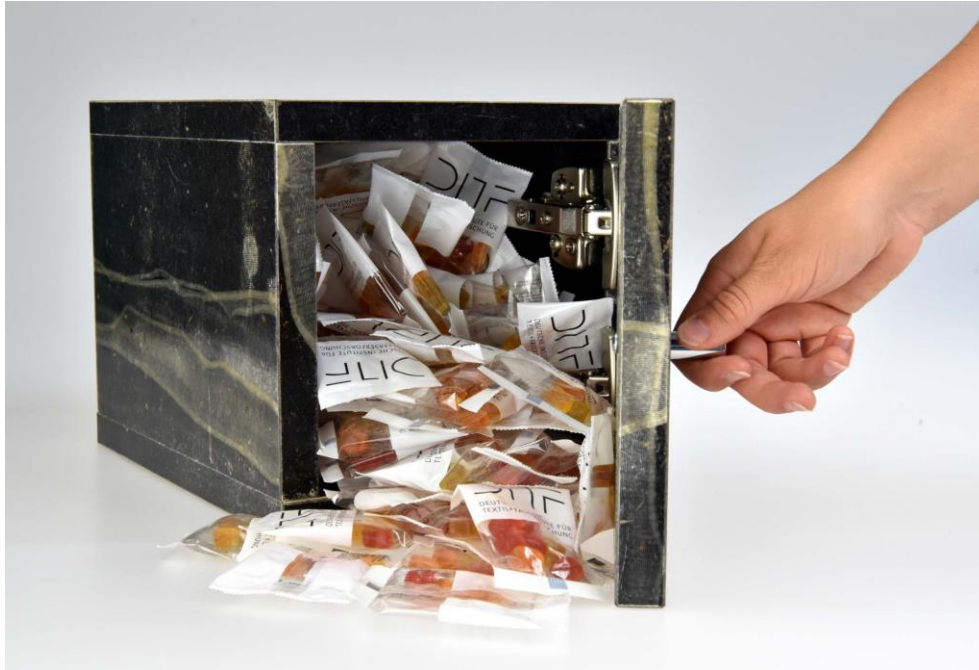
Kleines Möbelstück aus Gärrestverbundwerkstoff. Foto: DITF
