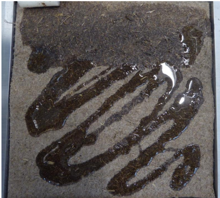
Tränken des Vlieses mit biobasiertem Harz. Foto: DITF
