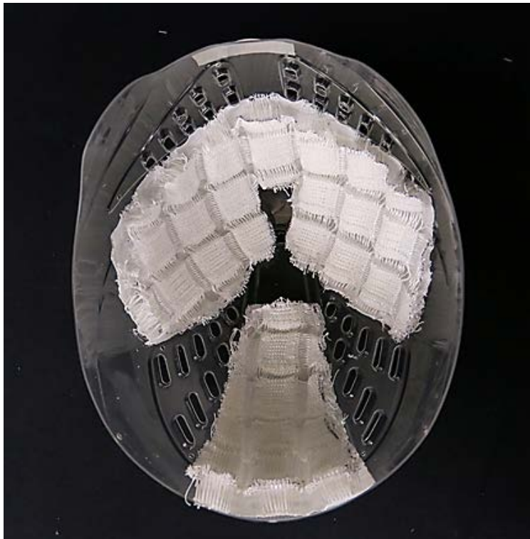
Foto 1: In die Helmschale eingelegtes Abstandsgewebe mit Füllöffnungen. Foto: DITF
