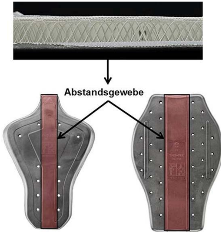
Foto 2: Gefertigte textilverstärkte Demonstratoren für den Bereich Rückenprotector. Foto: DITF
