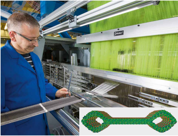
Endkonturnahe 3D-Gewebe mit Steckschützen-Webtechnik
