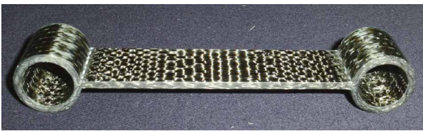
Konsolidiertes Bauteil aus einem 3D-Gewebe
