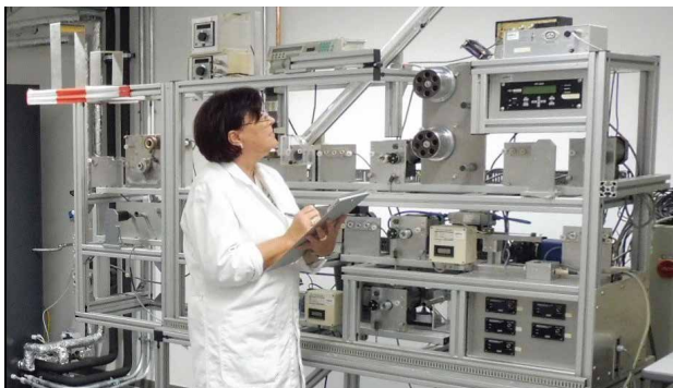
Quick-Size-Tester (Garnbeschichtung und Prüfung in einem Gerät)
