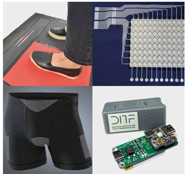
Oben links: Drucksensorische Matte zum Training des Gleichgewichts Oben rechts: textiles interaktives Display für Gestenerkennung Unten links: EMG Hose mit textilen Elektroden für Beckenbodentraining Unten rechts: selbstentwickelte Elektronik zur Erfassung und Auswertung des Signals eines textilen Dehnungssensors
