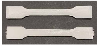
Links: Prüfmuster ohne und mit integriertem Garn; rechts: Prüfmuster, Matrix spröde in flüssigen Stickstoff gebrochen
