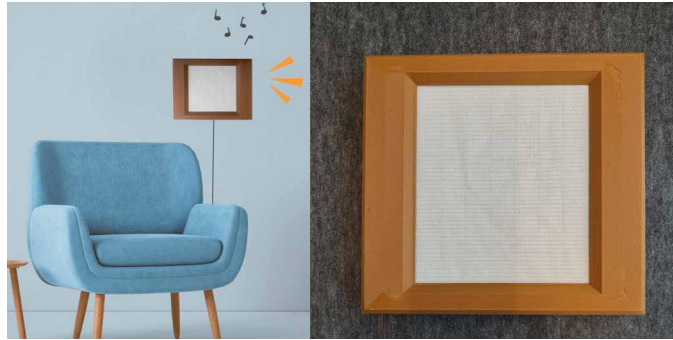
Links: Der textile Lautsprecher kann wie ein Bilderrahmen an die Wand gehängt werden und den Raum subtil beschallen. Rechts: Demonstrator des entwickelten Lautsprechers.
