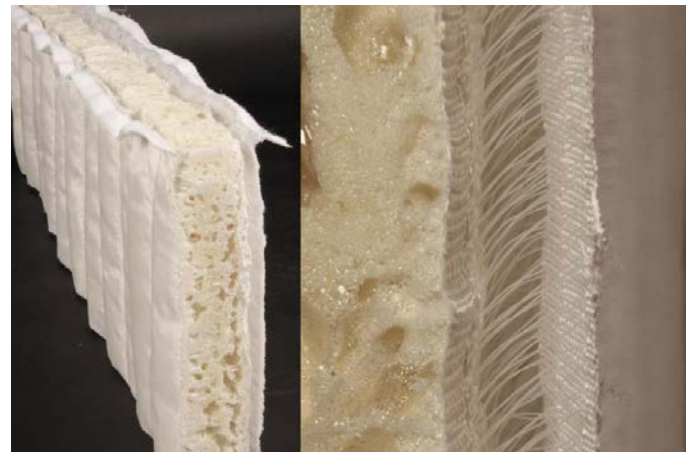
Abstandsgewebe, links horizontal aufgestellt und manuell mit PU-Schaum ausgeschäumt, rechts Schnitt durch Dämm- und Hinterlüftungsebene (Foto: FRA UAS)
