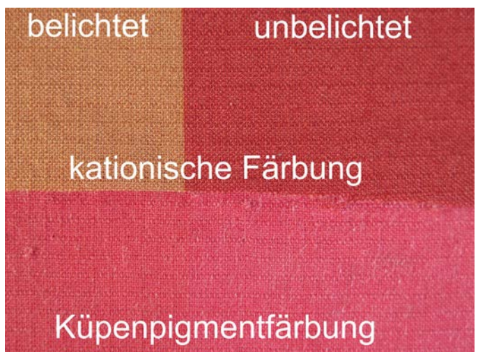
Lichteinfluss – Vergleich von kationischer und Küpenpigmentfärbung
