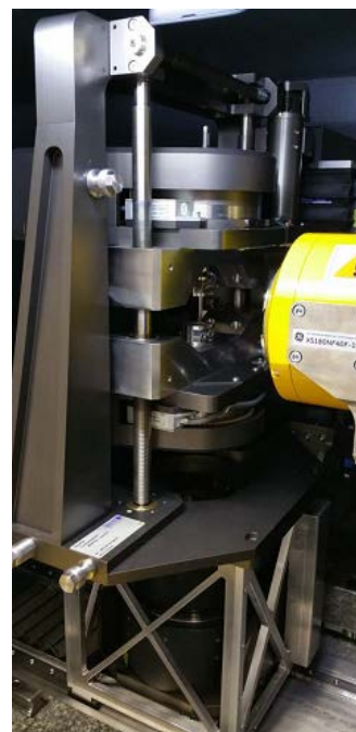
Prüfung mit der CT-insitu-Belastungsprüfvorrichtung (Torsion: Schulterzugprobe)
