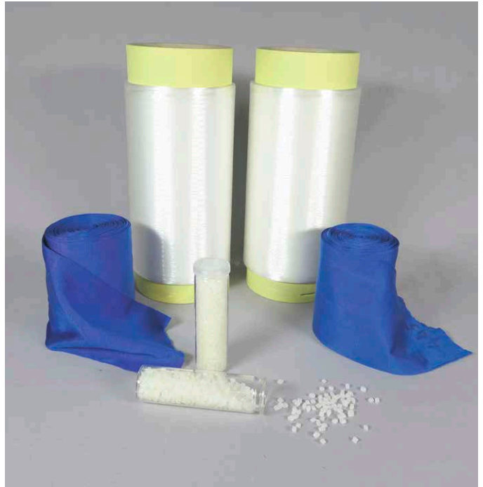
Granulat, Fasern und gefärbtes Gestrick aus flammgeschütztem Polyamid
