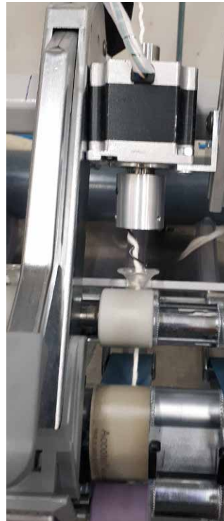
Drallorgan vor dem Streckwerk einer Ringspinnmaschine
