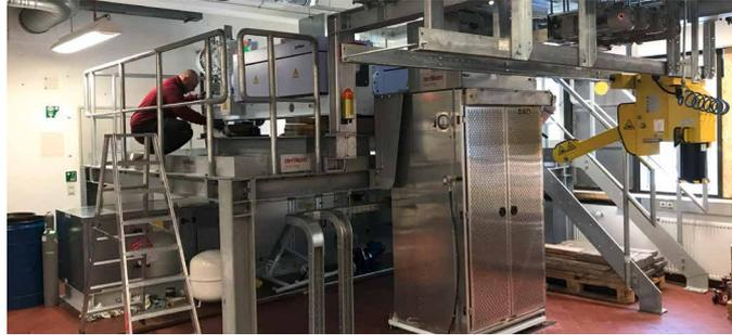
Bikomponenten-BCF-Spinnanlage der Firma Oerlikon Neumag
