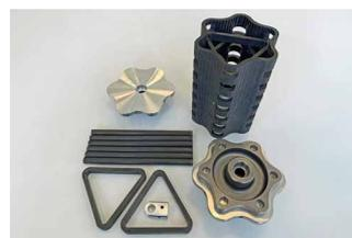
verbinden die Komponenten. Diese fasergerecht bestmögliche Nutzung des Potenzials der Carbonfasern führt zur maximalen Steifigkeit und Festigkeit des Werkzeugs. Es wiegt mindestens 50% weniger als herkömmliche Werkzeuge und ermöglicht mind. 50% höhere Betriebsdrehzahlen mit bis zu 1,5facher Produktionssteigerung. Die Entwicklung des „Extreme-Lightweight“ Lösungsprinzips erfolgte mit Hilfe von nume-
