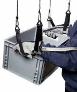
Unterstützung für Beschäftigte in der Logistik: Sensorische Handschuhe fordern je nach Last Hebeleistung beim Lastkran an
