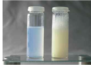
Bindemitteldispersion zur Herstellung elektrisch isolierender Tinten
