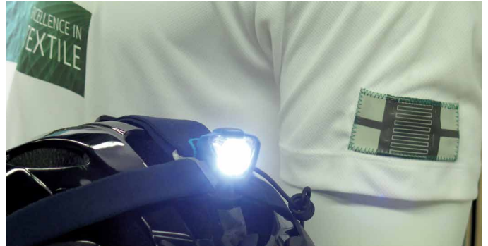
Näherungssensor auf Oberbekleidung mit angesteuerter LED-Beleuchtung
