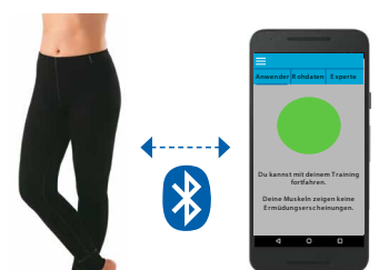
Sporthose mit Echtzeitmonitoring der Muskelfunktionen mit Hilfe der Elektromyografie
