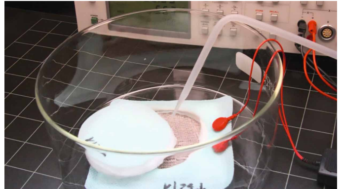
Bestimmung der Feuchte am Labormuster Wundabdeckung mit Sensorgarnen
