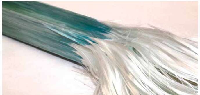
Glasfaserbündel im ersten Moment der Pultrusion zeigen die nur Millimetern dünnen Einzelfasern
