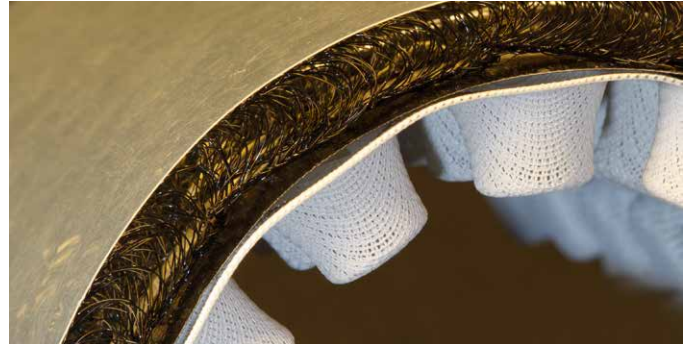
Modell des textilen Sonnenkollektors mit integriertem Speicher
