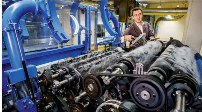
Reinigungsarbeiten an den mit Fasern belegten Arbeitsorganen der Krempel
