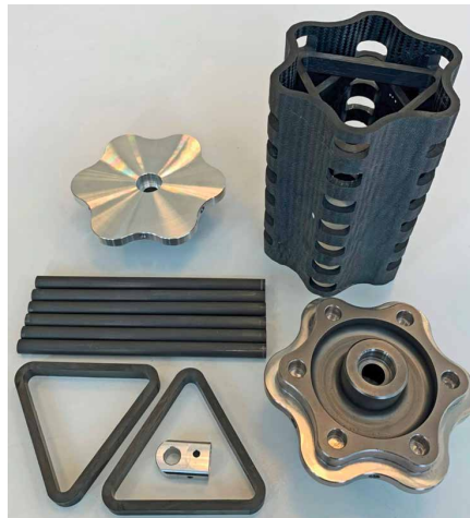
Demonstrator: Hobelkopf zur Holzbearbeitung mit größtmöglichem Materialersatz durch Kohlenstoff-Hochleistungsfasern (CFK)
