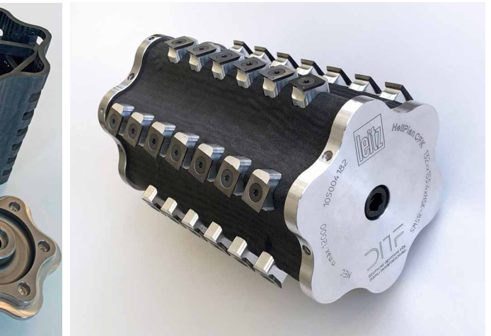
Demonstrator: Hobelkopf zur Holzbearbeitung mit größtmöglichem Materialersatz durch Kohlenstoff-Hochleistungsfasern (CFK)
