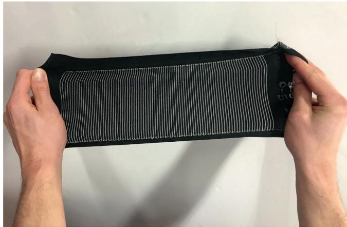
*Dehnbar und stabil: Demonstrator einer textilen Heizung*
