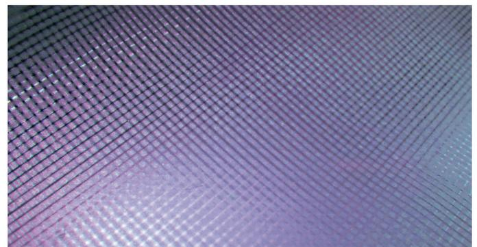
Glasfaserverstärkter Verbundwerkstoff mit UV-härtbaren Polymeren
