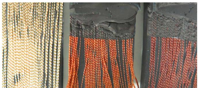
Haftung von Polyamid 6.6 an Kautschuk: ohne Haftvermittler (links) mit RFL-Dip (Mitte) mit HMF-Dip (rechts)
