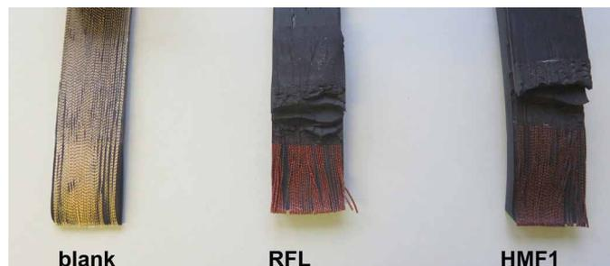
Verbund aus gediptem Cord und NR-SBR-Kautschuk nach dem Peel-Test
