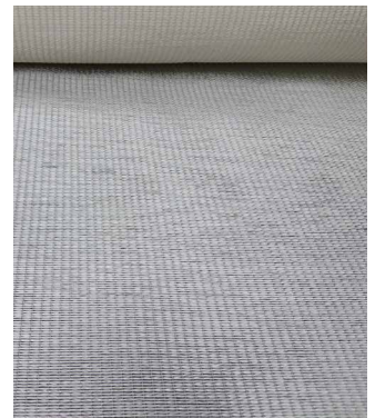
Hybridtextil hergestellt aus einem Hybridgarn
