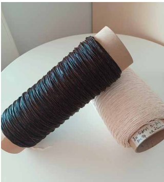
Baumwollgarne: braun mit Ligninbeschichtung als Schutzschicht gegen Abbau im Boden und weißes Referenzgarn ohne Beschichtung
