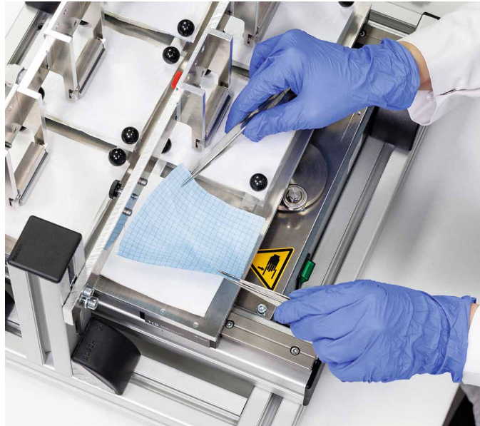
ReBa 2 -Prüfgerät zur Bestimmung des Keimdurchgangs bei Reinraumbekleidungstextilien
