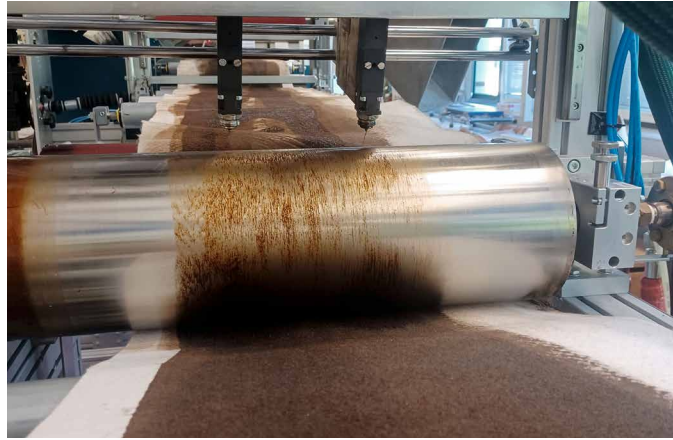
Vliesstoff auf Zellulosebasis wird mit dem aufgeschmolzenen Lignincompound als Schutzschicht gegen Abbau im Boden beschichtet.
