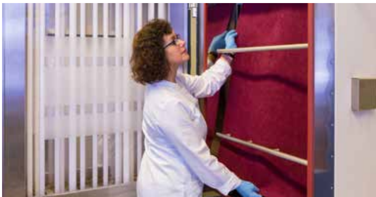
Global-UV-Testgerät Typ UV200 zur Bewitterungsprüfung im ITV-Umweltsimulationslabor
