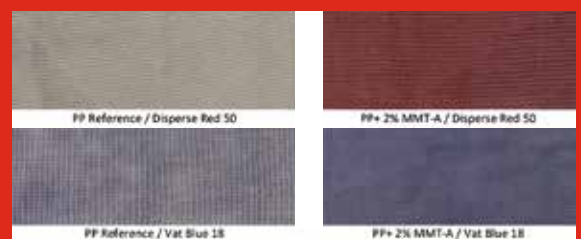
Ergebnisse der Färbversuche mit und ohne Kompoundierung mit Nanoclays zur Verbesserung der Anfärbbarkeit von PP-Fasern mit Küpen- und Dispersionsfarbstoffen
