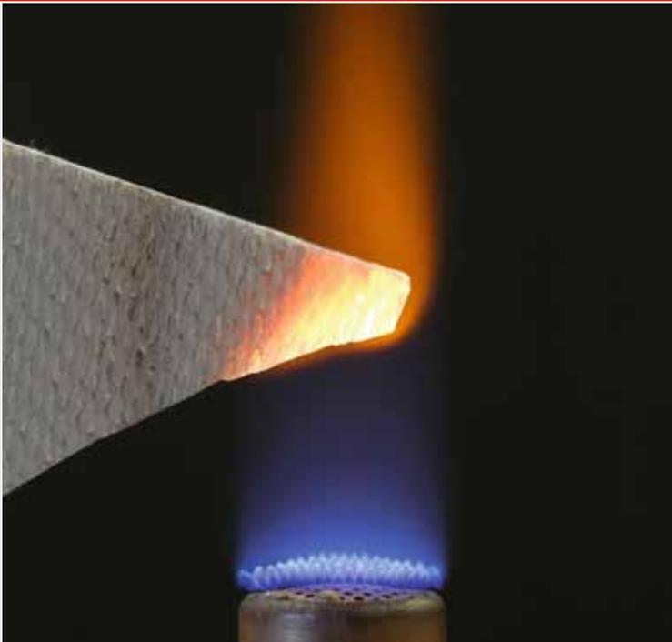
Hochtemperaturbeständige CMC im Brennversuch
