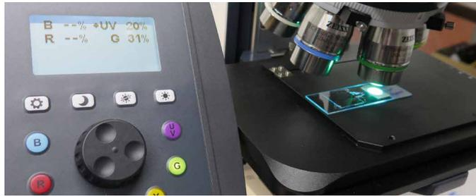
Carl Zeiss Colibri Fluoreszenzeinrichtung an Axioscope 5 Auflichtmikroskop
