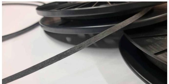
Entwickelte „Infinity“ rCF-Tape-Variante mit Besäumung der Tapeanten
