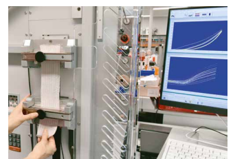
Messgerät zur Bestimmung des elektrischen Widerstands entlang der Kraft-Dehnungs-Kurven
