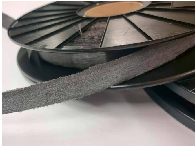
Tapes für Hochleistungsanwendungen hergestellt aus recycelten Carbonfasern
