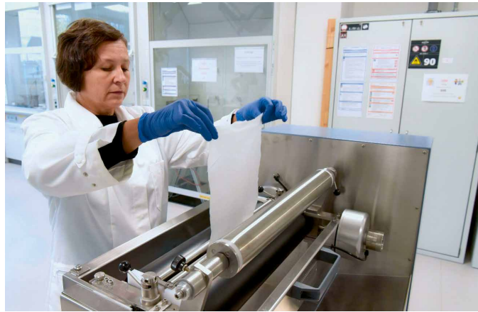
Ausrüstung eines Gewebes an einem Labor-Foulard
