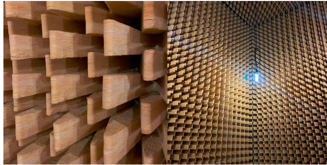
Schallabsorbierende Decke und Wände im Schallmessraum der DITF
